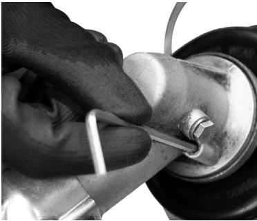
Fig. 11 – Trabando el eje
