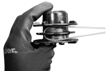
Fig. 14 – Passando o fio de nylon
